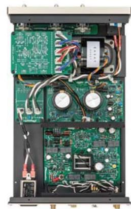
現代の主流を占めている負帰還アンプは入力信号と出力信号を常に比較し、この差を増幅します。しかし入力信号と出力信号の間には時間遅れがあり、これがTIN歪等を発生し負帰還アンプが音質的に満足できない原因の一つになってます。無帰還アンプでは負帰還アンプのような比較/補正動作は有りませんので、構成する部品、回路に高い精度/技術を要求されます。その結果、音源(レコード)の情報を余すことなく再生する事が出来、音楽の躍動感、ダイナミクス、陰影等の表現に優れた再生が可能になりました。
