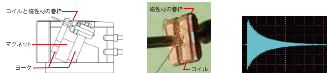
図1. カートリッジ構造
